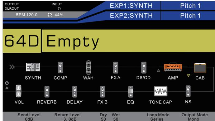
Loop 모드는 직렬(Serial)로 설정하고 Send 아이콘 ▲ 과 Return 아이콘 ▼ 은 시그널 체인 AMP 블록의 앞과 뒤에 각각 위치 시킵니다.
