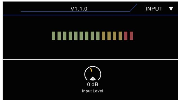
SYSTEM 메뉴의 INPUT에 들어가 악기를 연주해보고 인풋 레벨의 변화를 화면으로 확인합니다. 컨트롤 노브 1번으로 인풋 레벨을 부스트 하거나 내립니다. 최적의 레벨은 인풋 레벨이 노란색 부분까지 올라가도록 하는 세팅입니다. 인풋 레벨이 초록색 부분까지만 올라간다면 레벨이 너무 낮게 설정된 세팅입니다.
