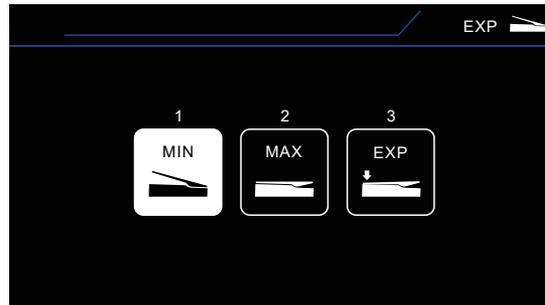
1. MIN : EXP 페달을 사용자가 원하는 힐다운(heel down) 포지션에 놓고 SELECT 노브를 누르면 설정값이 저장되며 2번 MAX로 넘어갑니다.
