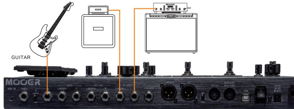
XLR 아웃풋을 PA 시스템에 연결함과 동시에 1/4" OUTPUT 단자를 기타앰프에 연결한다면 CAB 모듈을 시그널체인의 가장 마지막에 놓고 OUTPUT I/O(▲)를 CAB 모듈 바로 앞에 위치 시킵니다
