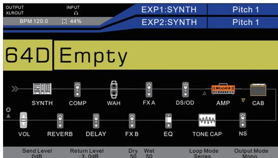
Loop 모드를 병렬로(Parellel) 설정 해놓습니다. 딜레이나 리버브를 FX LOOP에 병렬 모드로 연결해놓고 DRY/WET 파라미터 값을 조절하여 Wet 사운드의 양을 원하는 만큼 조절 할 수 있습니다. 리버브 페달을 스테레오로 연결할때 FX LOOP의 Output 모드를 Stereo로 설정합니다.
