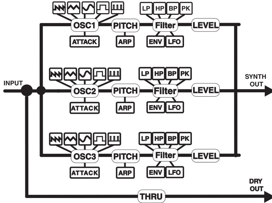
위의 다이어그램에서 볼 수 있듯이, SYNTH ENGINE은 3개의 독립적인 보이스를 갖고있습니다. 각각의 독립된 Waveform과 Pitch, Attack, Level, Filter 등의 파라미터를 갖고 있습니다. 인풋을 통해 입력된 악기의 시그널 패스가 분리되어 각각의 SYNTH 보이스에 병렬로 라우팅되며 각각의 독립적인 프로세스를 거칩니다. THRU 드라이 시그널은 페이지 4번의 'Thru Level' 파라미터를 이용해 전체 SYNTH 이펙트 블록 병렬로 믹스될 수 있습니다.
